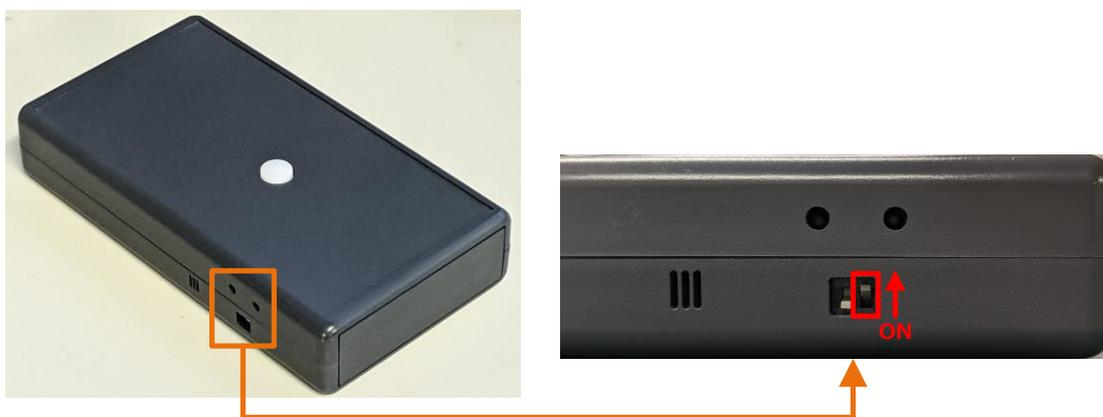
※本体正面（白い突起物のある面）を上に向けた時、本体側面にある 2 つのスイッチの右側がスイッチ 1 になります。このスイッチを上へ倒してください。
